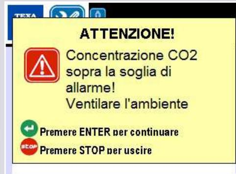
Il software TEXA, avvisa l'operatore se, a causa dello scarico del CO<sub>2</sub> contenuto nell'impianto, l'area di lavoro risulta non sicura.
