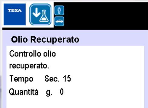
La bilancia elettronica permette di misurare con estrema accuratezza la quantità di olio recuperato durante il servizio di manutenzione.
