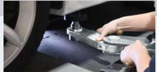
Possibilità di utilizzare il braccio in modalità standard o inclinato fino a 90°.
