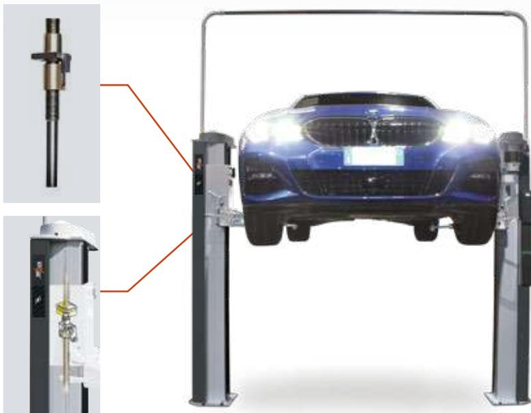
Il movimento del carrello è assicurato da una vite in acciaio rollato ed una busta in bronzo con lubrificazione automatica; elementi ad alta resistenza atti ad assicurare la massima sicurezza e la durata nel tempo.
