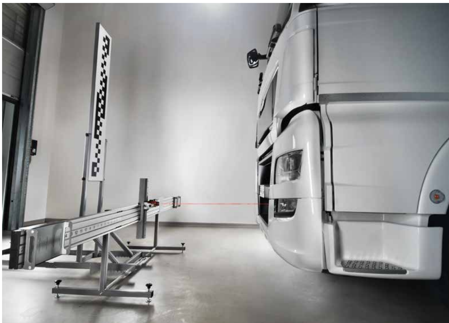
Scala graduata magnetica per controllo allineamento telaio
